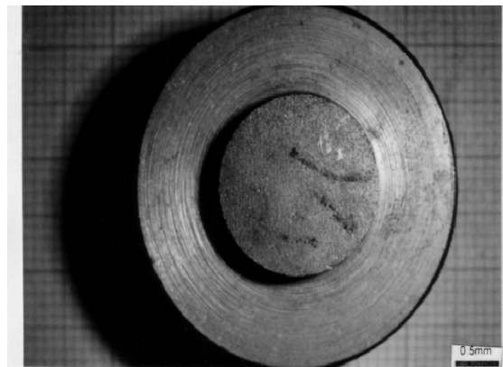
شکل ۲. تصویر استوانه متصل شده تولیدی به روش متالورژی به رینگ CK35 به روش نفوذی
