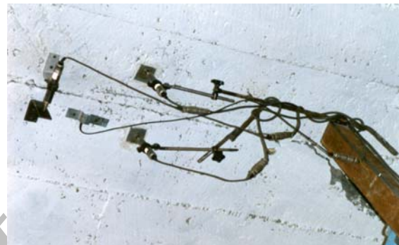
شکل ۲. ترک در محل کلید قوس و تغییر مکان سنج‌ها و یکی از شتاب‌سنج‌های نصب شده در طرفین ترک
