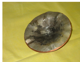
شکل ۶-آ. اتصال آلومینیوم به مس در تکیه گاه آزاد
