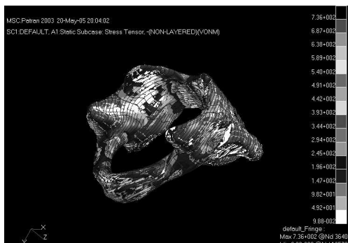
شکل ۸. کانتور توزیع تنش در بارگذاری نرمال (نشان دهنده تمرکز تنش در کمان خلفی)
