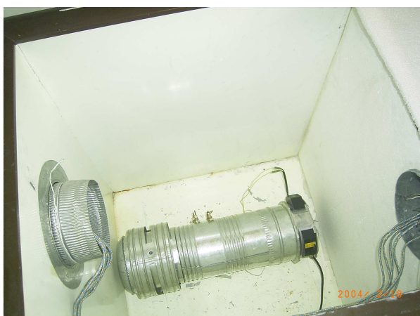
قرارگیری هیتر در محفظه اول برای آزمایش کالیبراسیون (دو هیتری)
