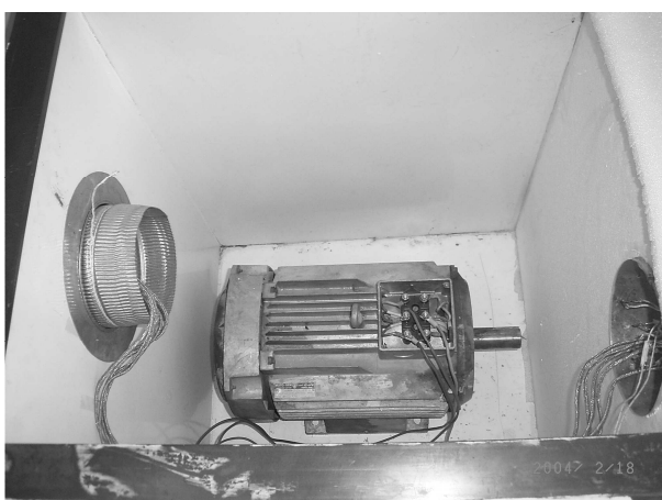
قرارگیری موتور القایی در محفظه اول برای آزمایش بی باری
