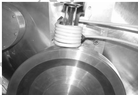
شکل ۲. پیچه القایی و دیسک مسی دستگاه ذوب‌ریسی
