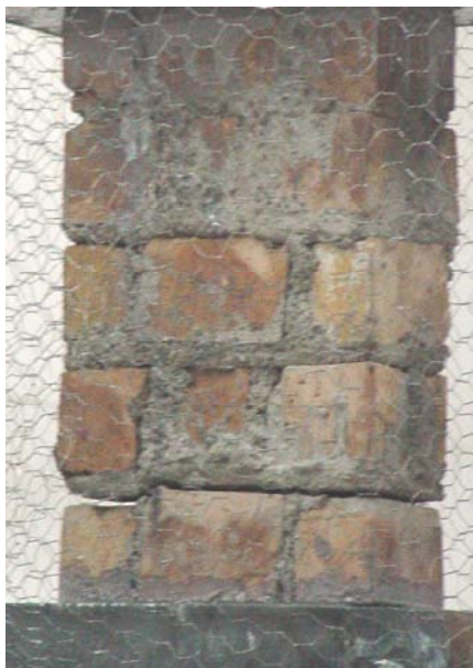
شکل ۵. نحوه ترک خوردگی در نمونه شماره ۱ در زمان انتهای آزمایش
