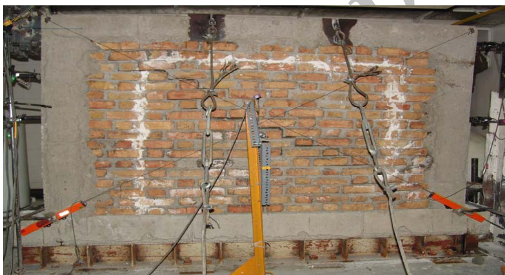
شکل ۱۳. گسیختگی برشی و ترک خوردگی مایل در دیوار آجری کلافدار B
