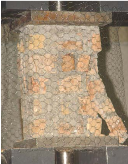
شکل ۳. نحوه ترک خوردگی و گسترش شکست در نمونه شماره ۳ در زمان انتهای آزمایش
