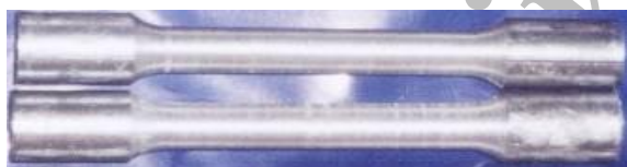
شکل ۶. نمونه آزمایش کشش ساخته شده در این تحقیق
