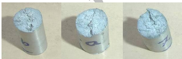
شکل ۷. برخی از نمونه های آماده شده برای بررسی سطوح شکست
