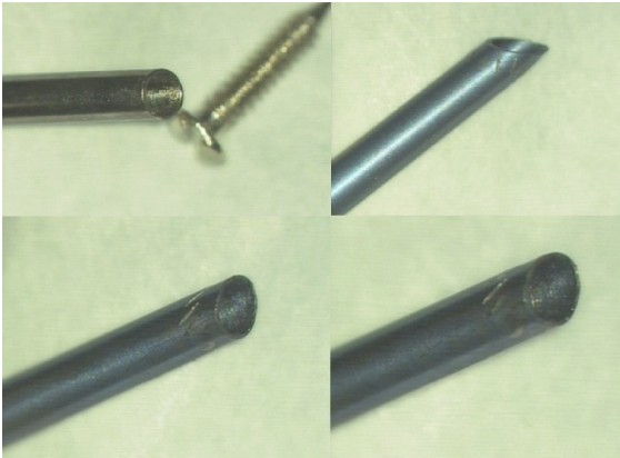
بالا چپ: پیچ به کار رفته جهت ایجاد شیار داخلی بالا راست: شیارهای بیرونی
