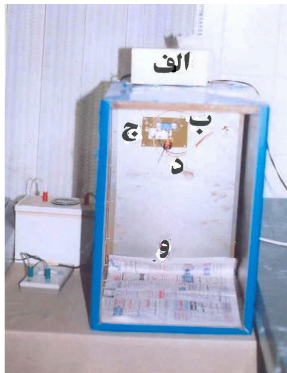
شکل 1. دستگاه مولد امواج شبیه سازی شده تلفن های همراه (940 مگاهرتز)
