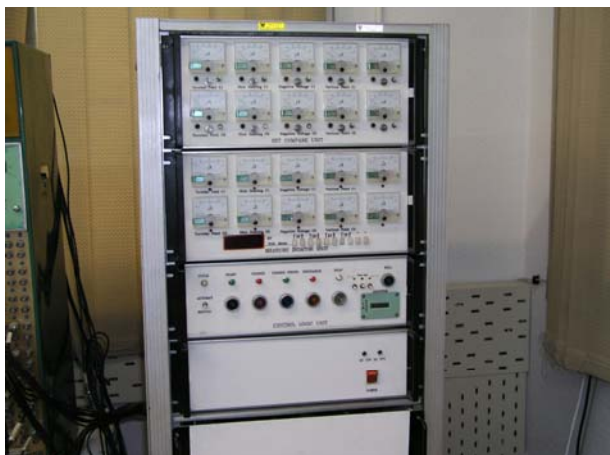
شکل (۷): تابلوی فرمان شارژ و دشارژ خازنها و تابلوی تنظیم زمان تخلیه
