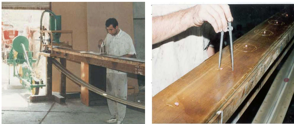
شکل ۳: نمایی از شبیه‌سازی حفره روی گریس‌بالت با استفاده از پرگار.
