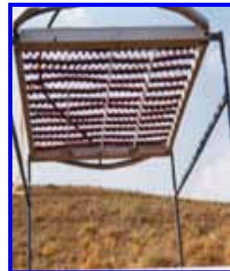
شکل ۲: صفحه‌ی ریزش باران دستگاه باران‌ساز (سمت راست)، نمونه‌ای از کرت آزمایشی مستقر در زیر باران‌ساز (وسط) و مجموعه سامانه آزمایشی (سمت چپ) در منطقه مورد مطالعه (اقتباس از رئیس‌یان و چرخابی، ۱۳۸۳)
