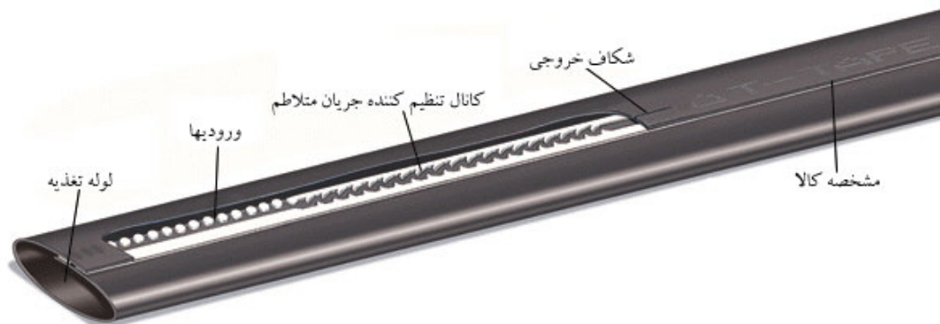
شکل ۱: لوله آبیاری قطره‌ای نواری (Tape)
