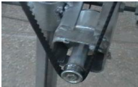
شکل 11: ژنراتور (دینام) 6 ولتی استفاده شده در مدل توربین بادی
