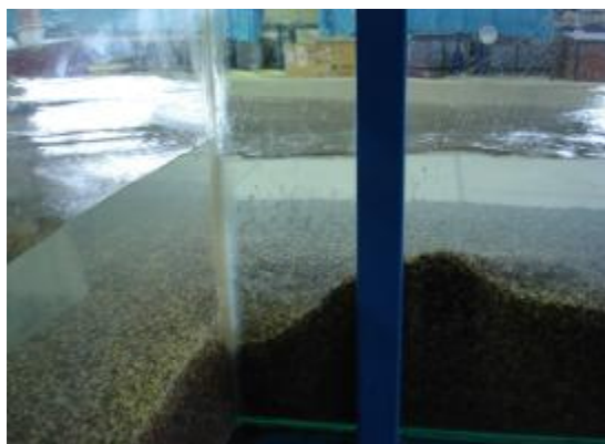
شکل 3: پرتاب ذرات رسوب کنده شده از چاله فرسایشی به سطح آب
