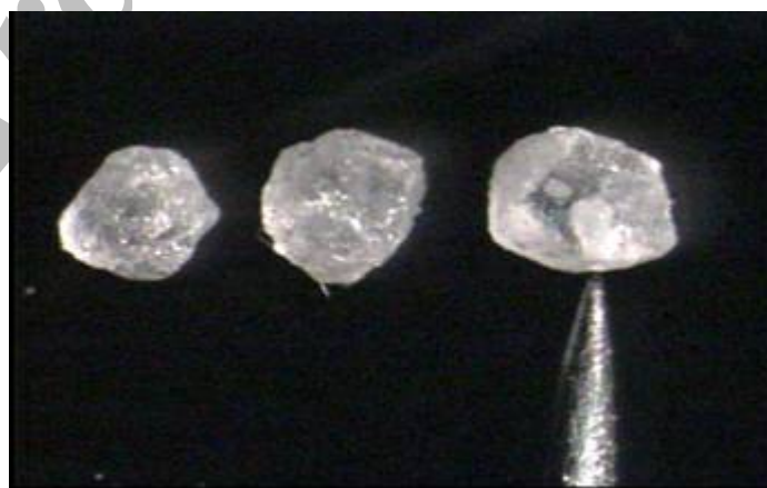
شکل ۱ مقایسه بلور اسید سیتریک تیمار نشده (چپ)؛ اسید سیتریک آغشته به ژلاتین پودری (وسط)؛ و بلور اسید سیتریک پوشش دار شده با ژلاتین پودری (راست) توسط امواج مایکروویو در مدت ۲۹۰ ثانیه (تصویربرداری شده توسط دوچشمی آزمایشگاهی با بزرگ نمایی ۱/۵).
