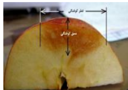
شکل 1 نحوه اندازه گیری ابعاد کوفتگی
