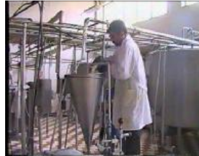
شکل 4 انتقال فاز آبی (شیر مایه خورده) به قیف تغذیه هموژنایزر
