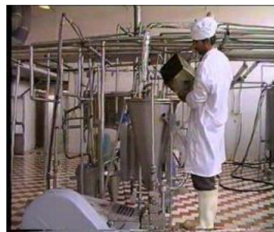
شکل 5 انتقال روغن به هموژنایزر
