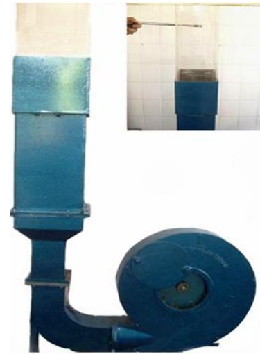
شکل 2 دستگاه مورد استفاده برای اندازه‌گیری سرعت حد
