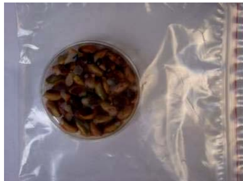
شکل ۲ طرح بسته بندی جهت بررسی اثرات ضد قارچی عصاره مریم گلی در مغز پسته سترون پوشش دیده با پوشش های حاوی عصاره در دمای ۲۵ درجه سانتی گراد و رطوبت نسبی ۷۵ درصد میزان گسترش رشد آ. فلاووس دیسک تلقیح شده (محیط کشت حاوی کشت ۹ روزه آ. فلاووس)
