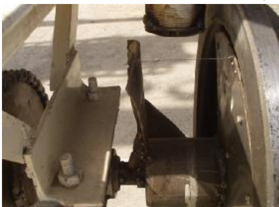
شکل ۱ شمایی از قسمت پایین دستگاه تقسیم کننده و چانه کن خمیر
