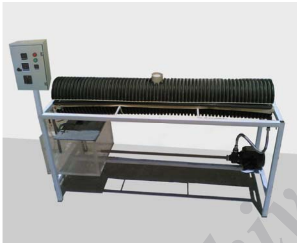
شکل ۳ سیستم ناپیوسته رفراکتانس ویندو ساخته شده در بخش صنایع غذایی دانشگاه شیراز. دارای گواهی ثبت اختراع به شماره ۶۷۴۹۰.
