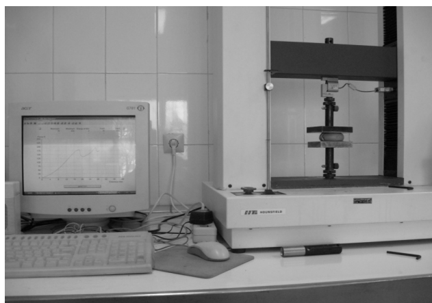
شکل ۱ نحوه آزمون نیروی شکست توسط دستگاه آزمون مواد
