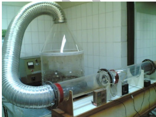
شکل ۱: وان آبکاری، محفظه استوانه ای و مخروطی هدایت کننده میست، لوله هدایت کننده میست به تونل تست و تونل تست
