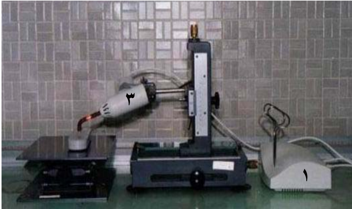
تصویر ۲: نمای کلی آزمایشگاهی شدت سنجی نوری پس از عبور از ضخامت های متفاوت مواد و نسوج دندان‌نی : ۱- بدنه دستگاه لایت کیور، ۲- گیره آزمایشگاهی قابل تنظیم، ۳- هند پیس دستگاه لایت کیور، ۴- میزک آزمایشگاهی قابل تنظیم، ۵- رادیومتر، ۶- نمونه آزمایشگاهی در محفظه حلقه مسی با قطر داخلی منطبق با قطر نمونه ها، که مقابل فتوسل رادیومتر قرار گرفته است.
