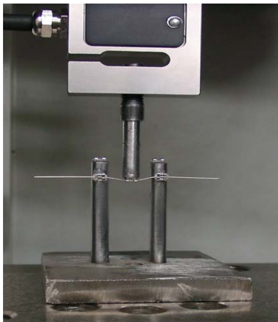
شکل ۱: فیکسچر و نمونه سیم در حالت خمش
