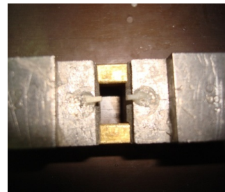
تصویر ۱: دستگاه استحکام ریزکشی به همراه میکروبار بعد از اعمال نیرو به میکروبار و ایجاد شکست
