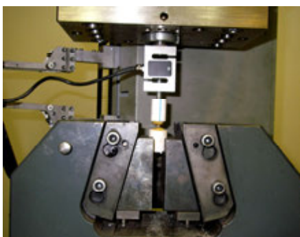
تصویر ۵: نمونه متصل به دستگاه کشش
