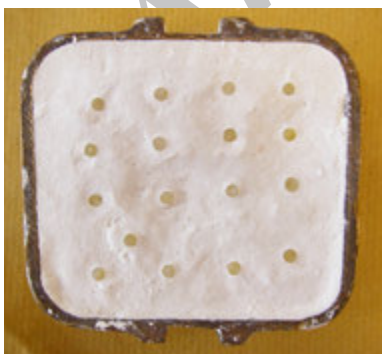
تصوير ۲: نمونه‌های دندانی به همراه دسته آكريلي خود در داخل گچ مدفون شده‌اند بگونه‌ای که فقط سطح مقطع دندانها، بدون هيچ گونه بيرون زدگی از گچ، نمایان می باشند.
