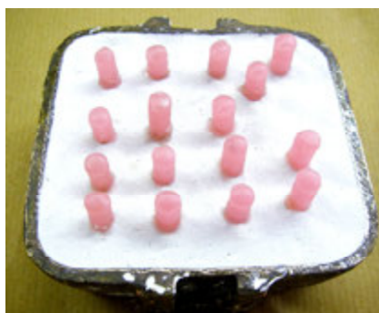
تصویر ۳: موم‌های استوانه‌ای به قطر ۸mm و طول ۱cm که به نمونه‌های دندانی متصل شده‌اند.
