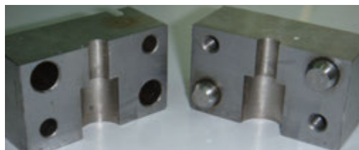
تصویر ۳: ایندکس تعیین کننده ضخامت ونیر
