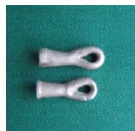
تصویر ۲: کوپینگ فلزی ساخته شده و حلقه متصل برای ایجاد کشش
