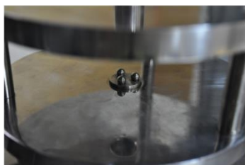
تصویر ۱: تست Piston on three balls در دستگاه
