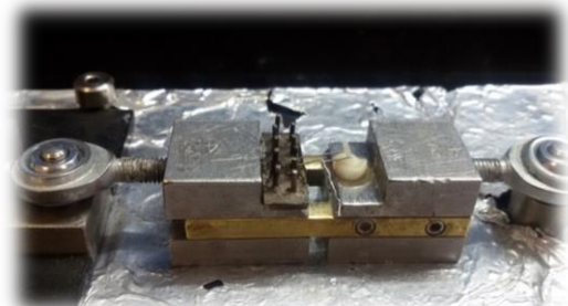
شکل ۴: فیکس شدن نمونه به بازو توسط چسب سیانوآکریلات
