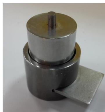
تصویر ۱: قالب استفاده شده در تهیه نمونه‌های آزمون‌های فیزیکی و مکانیکی بر اساس الزامات استاندارد ISO 24234: 2015
