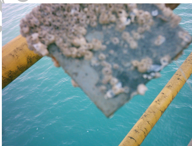
شکل ۳ سیستم ۳ با آماده سازی وایر برس بعد از ۶ ماه
