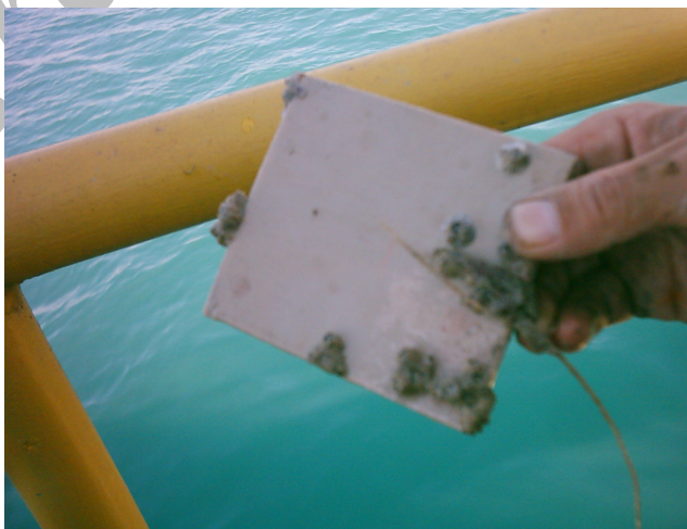
شکل ۲ سیستم ۲ با آماده‌سازی سند بلاست بعد از ۶ ماه
