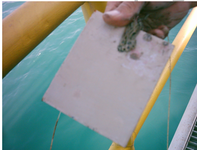
شکل ۱ سیستم ۱ با آماده‌سازی وایر برس بعد از ۶ ماه
