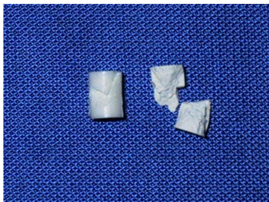
شکل شماره ۱- سمت راست، نمونه پلی کربوکسیلات بعد از تست استحکام فشاری. سمت چپ، نمونه گلاس آینومر تغییر یافته (زین بعد از انجم تست). جدول ۱- میانگین مدول الاستیک و استحکام فشاری و نحوه تغییر شکل سمانهای مورد بررسی
