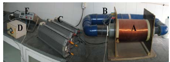
تصویر ۱: انکوباسیون متصل به دستگاه مولد میدان الکترومغناطیسی A؛ بوبین، B؛ سیستم انکوباسیون، C؛ (نُوستا)، D؛ فان، E؛ ولت‌سنج
