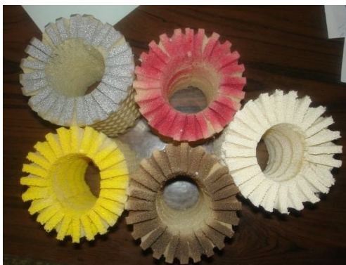
شکل ۱: المان‌های فومی، برش خاص توانسته رفتار الاستیک پلی‌یورتان را افزایش دهد
