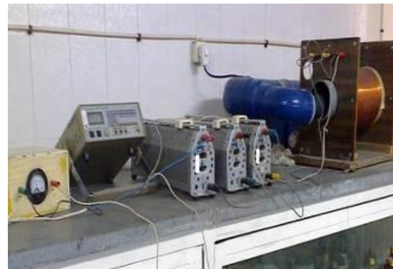
شکل ۱: سیستم مولد میدان الکترومغناطیس و انکوباسیون به
