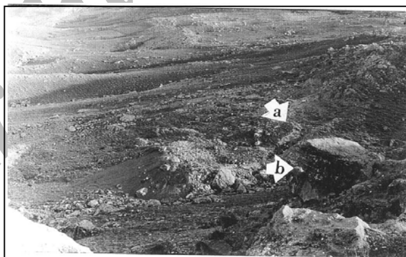
شکل (۱۰-۱): خروج آب‌های زیر قشری از درزها و شکاف‌های ایجاد شده در دامنه‌هایی که لغزش
