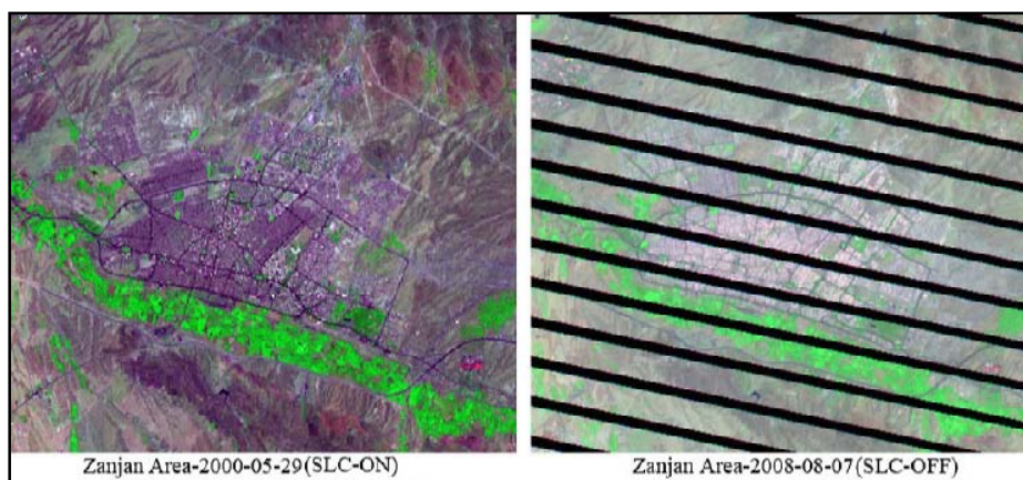
شکل ۲: تصویر ماهواره‌ای لندست ETM+ از منطقه زنجان قبل و بعد از معیوب شدن SLC مأخذ: تصاویر لندست، پردازش توسط نگارنده
