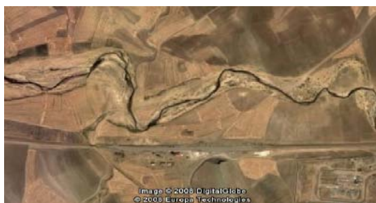
شکل ۲: نحوه‌ی جابجایی رودخانه قره‌آغاج در قطعه‌ای از مسیر (مسیرهای جدید و قدیم) و نحوه‌ی ترسیم مسیرهای قبلی از روی عکس‌های هوایی و تصاویر ماهواره‌ای و اندازه‌گیری میزان جابجایی (قطعه‌ای از مسیر رودخانه قره‌آغاج) مأخذ: نگارنده (تصویر سمت چپ برگرفته از earth google)
