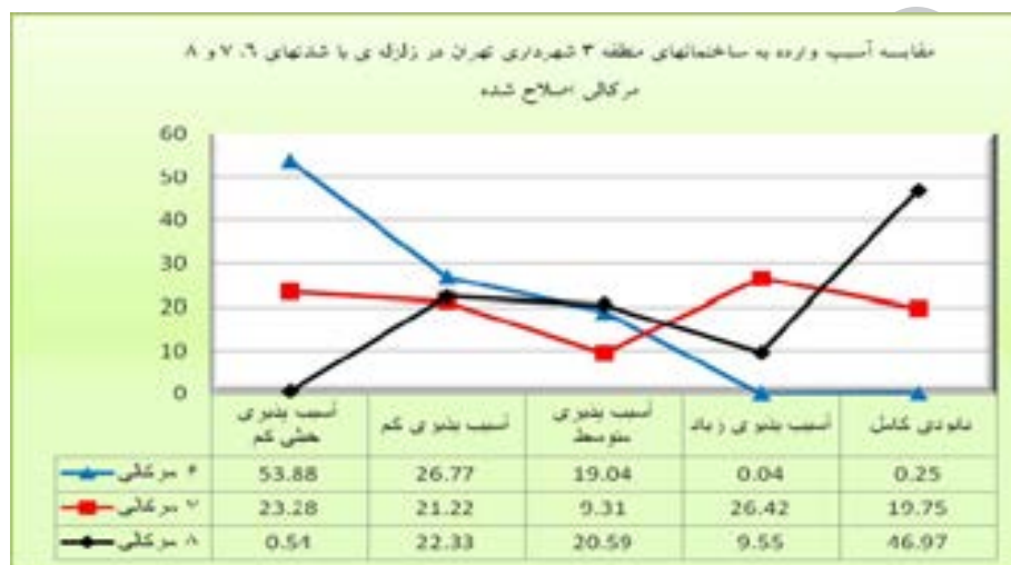
شکل ۷: نمودار مقایسه‌ی آسیب وارده به ساختمان‌های منطقه ۳ شهرداری تهران در زلزله‌ی با شدت‌های ۶، ۷ و ۸ مرکالی اصلاح شده مأخذ: مطالعات میدانی نگارندگان، ۱۳۹۰: ۷۷
