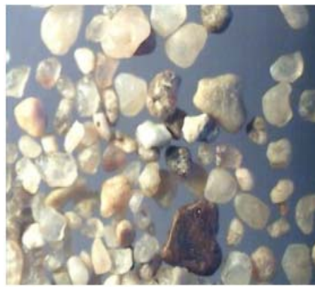
شکل ۴: دانه ساییده شده از نوع آبی تهیه و ترسیم: نگارندگان، ۱۳۹۵
