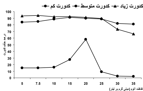
نمودار ۵: تعیین غلظت بهینه آلوم در کدورت‌های کم (کمتر از 30 \text{ NTU} )، کدورت متوسط ( 100-130 \text{ NTU} ) و کدورت‌های بالا ( 200-230 \text{ NTU} ) ( \text{pH}=7 )
