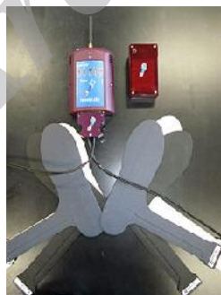
شکل ۱: سیستم اندازه‌گیری فشار کف‌پایی پدار
