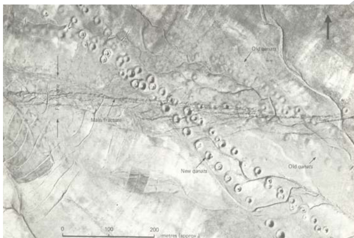
شکل ۱. جابه‌جایی قنات‌ها نشان دهنده فعال بودن زون گسلی فردوس در دوره‌های تاریخی است (آمبرسیز و ملویل، ۱۹۸۲). علامت پیکان در گوشه بالا سمت راست، جهت شمال را نشان می‌دهد.
