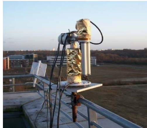
شکل ۱. تصویری از یک دستگاه نورسنج خورشیدی سیمبل به همراه بخش‌های اصلی آن؛ عکس سمت راست، دستگاه را در وضعیت اندازه‌گیری نشان می‌دهد.
