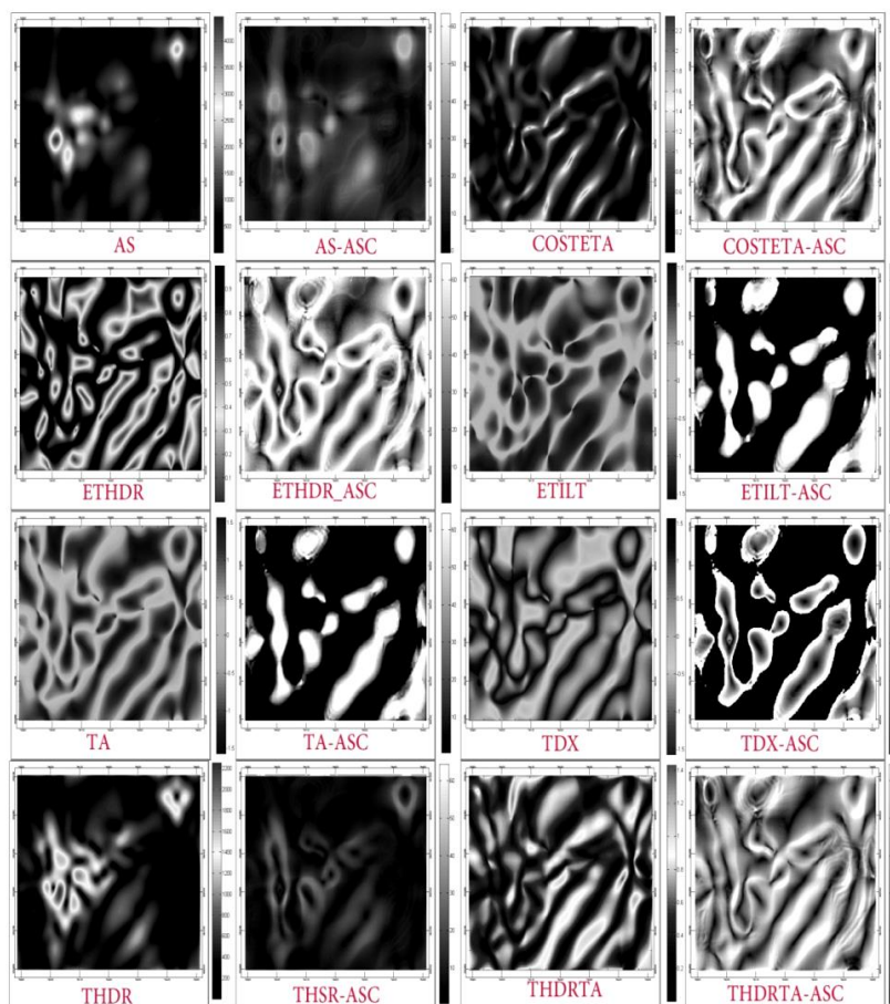
شکل ۱۰. نتایج اعمال فیلترهای مختلف روی داده‌های مغناطیس‌سنجی اجت‌آباد سمنان. شکل‌هایی که پسوند ASC دارند، نتیجه روش تجزیه طیف رنگی و شکل‌های بدون پسوند، نتیجه اعمال مستقیم فیلترها هستند.
