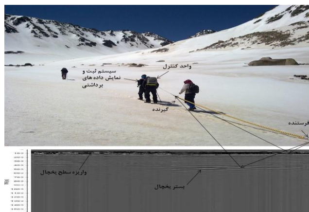
شکل ۱. تصویری از برداشت داده‌های GPR روی یخچال علم‌کوه و نمایش قسمت‌های مختلف سیستم GPR
